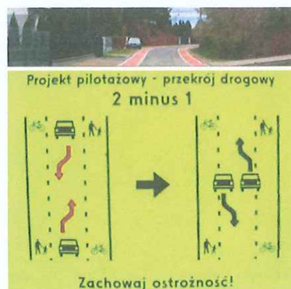
Fot. 3. Pilotażowy projekt drogi 2-1 w Niepołomicach
